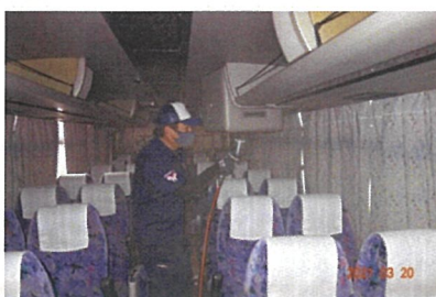
光触媒施工の様子
